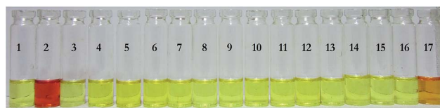
Fig. 2 Visual Colorimetric response of L with different anions ((1) L (blank), (2) F^- , (3) Cl^- , (4) Br^- , (5) I^- , (6) HPO_4^{2-} , (7) SO_4^{2-} , (8) C_2O_4^{2-} , (9) SCN^- , (10) HSO_4^- , (11) ClO_4^- , (12) PF_6^- , (13) BF_4^- , (14) N_3^- , (15) NO_2^- , (16) NO_3^- , (17) OAc^- ).
